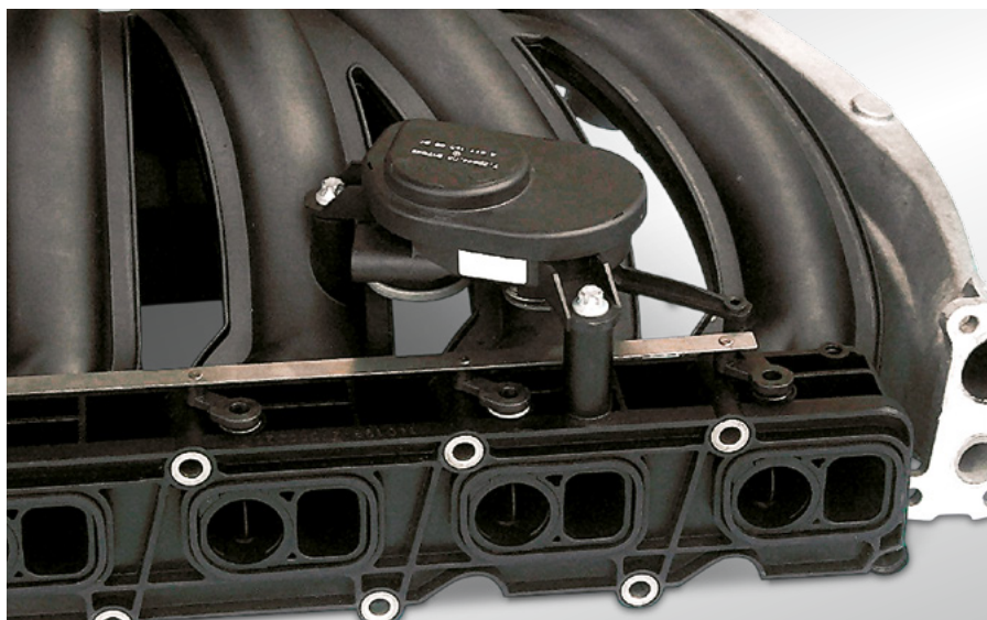
Рис. 41 Впускная труба с перекидными заслонками и EAM-i
