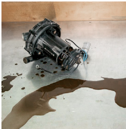
Рис. 28 Конденсат в насосе вторичного воздуха
