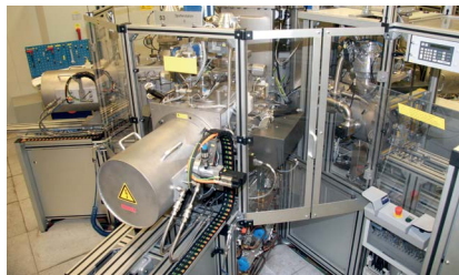
El procedimiento PVD: Revestimiento por magnetrón.
