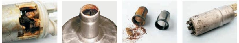
Schmutzschaden durch Trockenlauf
