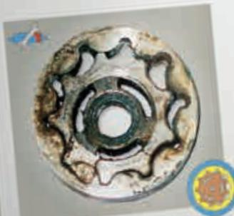
Fig. 19: Mecanismo de bombeo bloqueado (engranaje torcido) de una bomba de engranaje E3T
