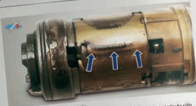
Fig. 17: Bomba de combustible sucia. La ilustración muestra una bomba de combustible muy sucia. La carcasa exterior ha sido retirada y se nota que los sedimentos de las partículas impuras corren lateralmente.
