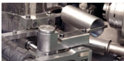
Шлифование рабочей поверхности поршневого кольца
