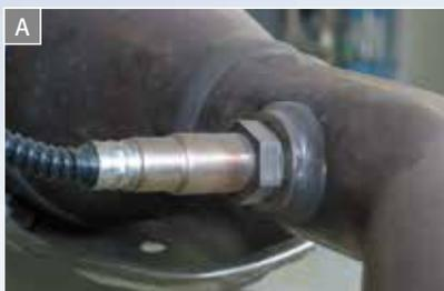
**A** Les températures de service élevées et les gaz d'échappement agressifs sont autant de défis pour les sondes lambda.
