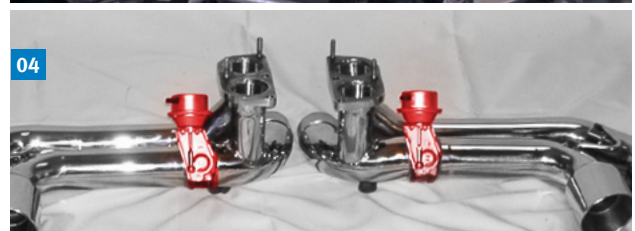
01–04 Eine Vielzahl von Bauteilen benötigt Unterdruck
