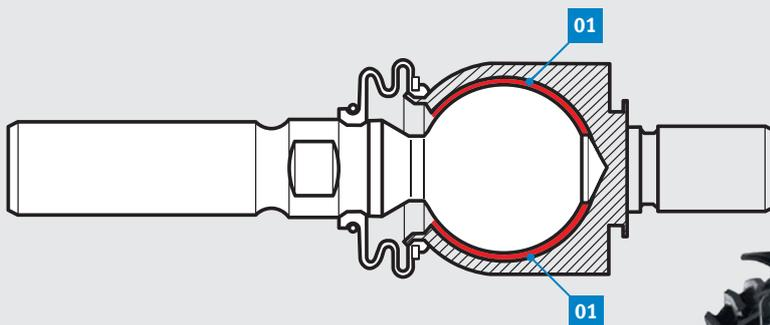
Kugelgelenkkopf in Traktorlenkgestänge, Lagerung mit KS Permaglide® Gleitlager-Kugelschalen Bauart PAX ... P200 (1)
