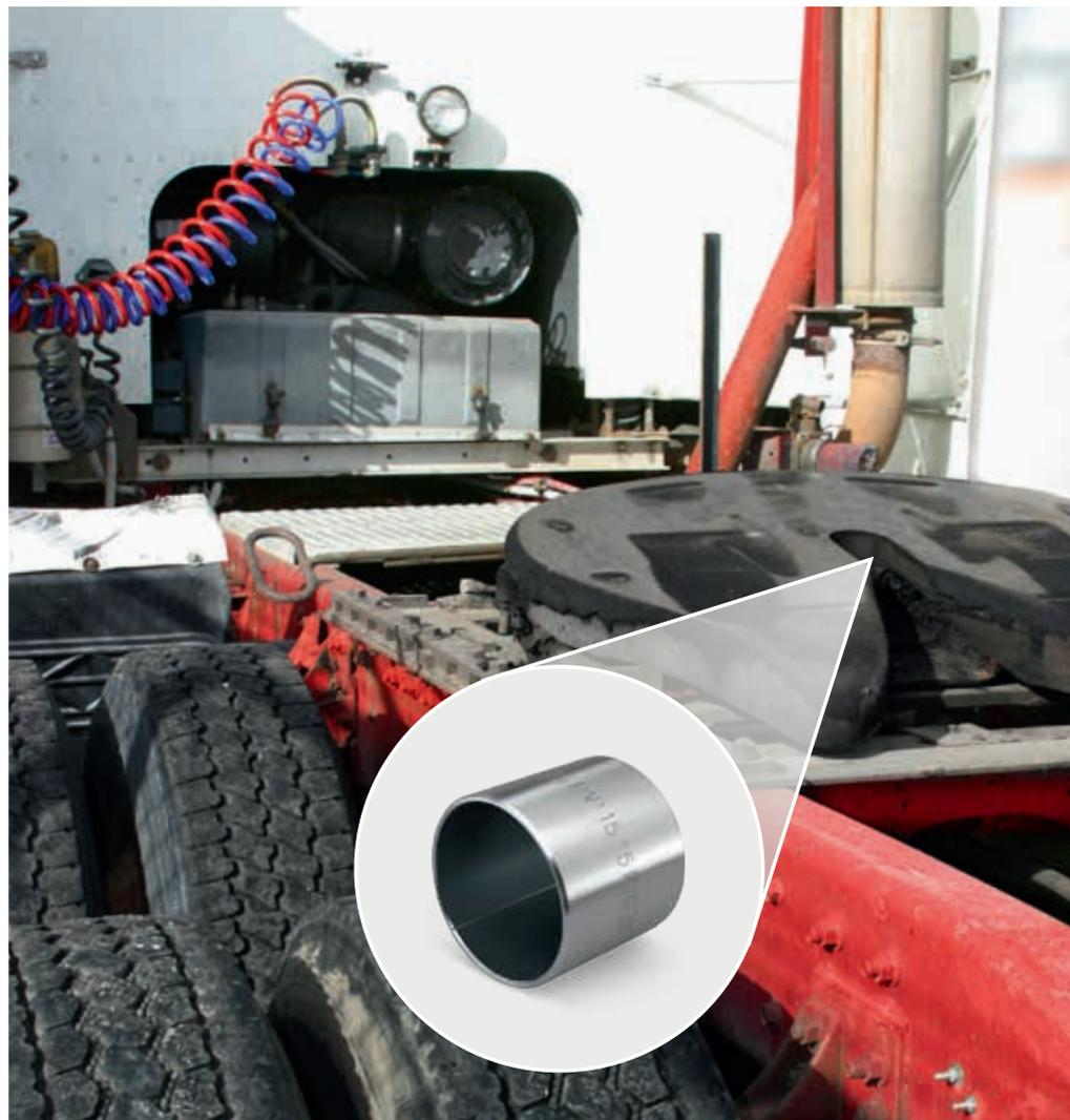
Lagerung in Sattelkupplung mit PERMAGLIDE® P10 Gleitlagerbuchsen
