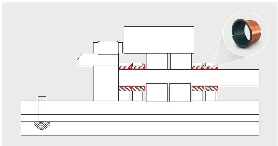
Supporti all'interno di un carrello della catena con boccola flangiata KS PERMAGLIDE® della forma costruttiva PAF ... P11
