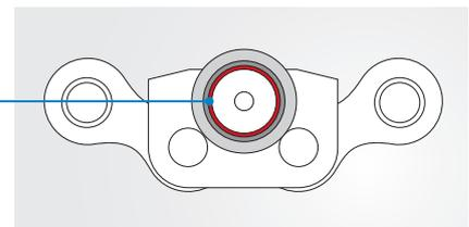
Lagerungen in Mitnehmerketten von Hochregalhubwagen mit KS Permaglide® Gleitlagerbuchse Bauart PAP ... P200
