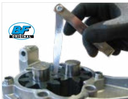
Минимальный зазор между зубьями шестерён, обеспечиваемый высочайшим качеством механической обработки при изготовлении, гарантирует равномерность работы, низкий уровень шума и долговечность.
