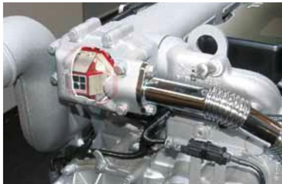
Rückschlagventil am Motor (optisch aufgeschnitten)
