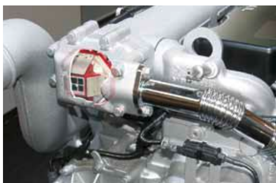
Clapet anti-retour monté sur le moteur (en vue écorchée)
