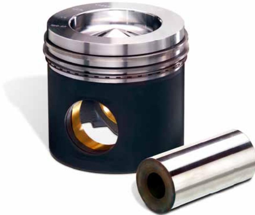
Der aus Stahl gefertigte Kolbenkopf garantiert geringste Verschleißwerte. Das verringerte Feuerstegspiel in Kombination mit den in Stahl geführten Ringen ermöglicht einen konstant niedrigen Ölverbrauch. Lange Laufzeiten und günstige Abgasemissionen sind das Ergebnis.
