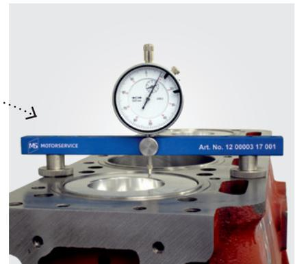
Durante la revisione e il montaggio dei motori occorre verificare e eventualmente impostare alcune importanti misure come le sporgenze dei componenti. Soprattutto durante il montaggio di pistoni, canne cilindro e valvole è necessario verificare e eventualmente impostare o rettificare la sporgenza/l'arretramento prescritti dal produttore.
