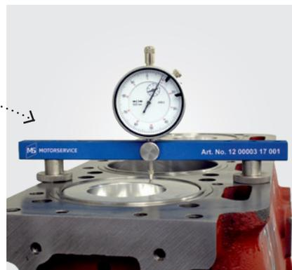
При ремонте или сборке двигателей подлежат проверке и, при необходимости, регулировке некоторые важные размеры выступов деталей. Особенно при установке поршней, гильз цилиндров и клапанов выступы / отступы, предписанные производителем, должны быть проверены и, при необходимости, отрегулированы или доработаны.
