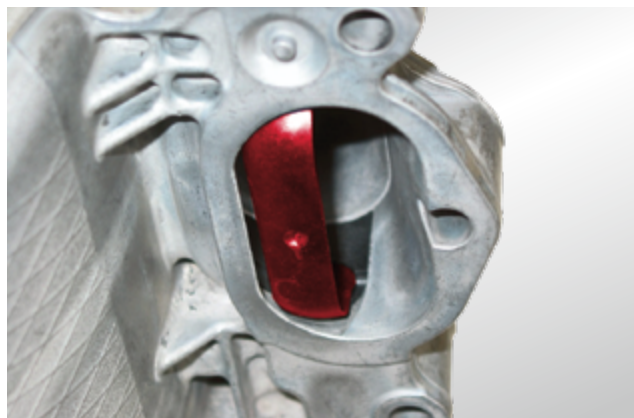
Перекидная заслонка (выделена красным цветом) для режима послойного заряда
