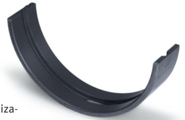
Los nuevos cojinetes de fricción disponen de un revestimiento de rodadura de polímero adicional, de forma que el metal antifricción y el revestimiento de polímero puedan tener diferentes tareas. Ya que la capacidad de adaptación, la resistencia al desgaste y la simultánea capacidad de carga son requisitos sumamente contrarios.
