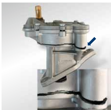
Ill. 1: brud i pumpehuset
