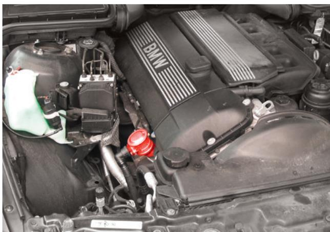
Le valvole dell'aria secondaria fanno parte del sistema dell'aria secondaria e sono montate tra la pompa dell'aria secondaria (01) e il collettore dei gas di scarico. Esse impediscono che picchi di pressione nel sistema dei gas di scarico causino danni nel sistema dell'aria secondaria e che il gas di scarico o la condensa giungano nella pompa dell'aria secondaria.
