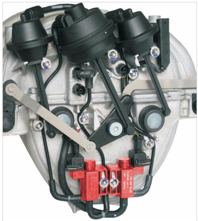
Esempi di impiego: tubo di aspirazione con valvole elettropneumatiche (evidenziate in rosso) nella Mercedes-Benz Classe C
