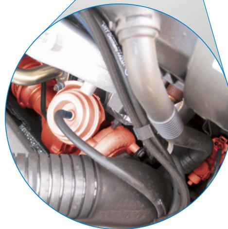
Convertitore di pressione e il compressore VTG (evidenziati in rosso) nell'Audi A4 TDI
