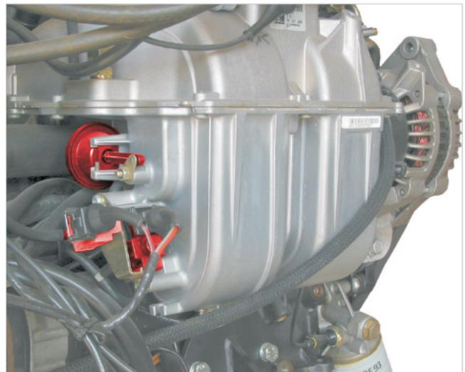
Sul collettore di aspirazione a geometria variabile nella Opel Astra sono applicate due valvole di commutazione (evidenziate in rosso). Una comanda le valvole tubo di aspirazione tramite la capsula posta sopra (evidenziata in rosso), mentre l'altra regola la valvola di disinserimento dell'aria secondaria (non rappresentata).
