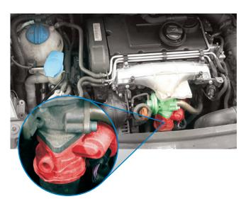
Vista de um compartimento do motor de um VW Touran destaque em verde: Válvula EGR; destaque em vermelho: Válvula reguladora
