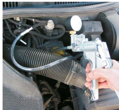
Il funzionamento delle valvole EGR pneumatiche o, come in questo caso, di un convertitore di pressione: Può essere facilmente controllato con una pompa di depressione manuale.
