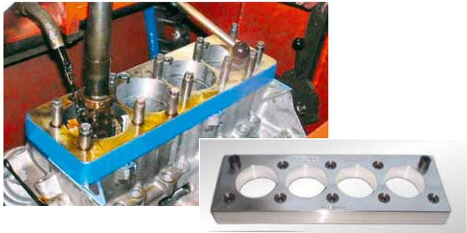
Figura 04: Brunimento do bloco com placa torquçada.
