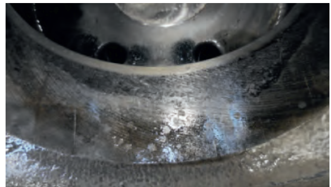
Oberflächenschäden durch Mikroreibung an einem Getriebe
