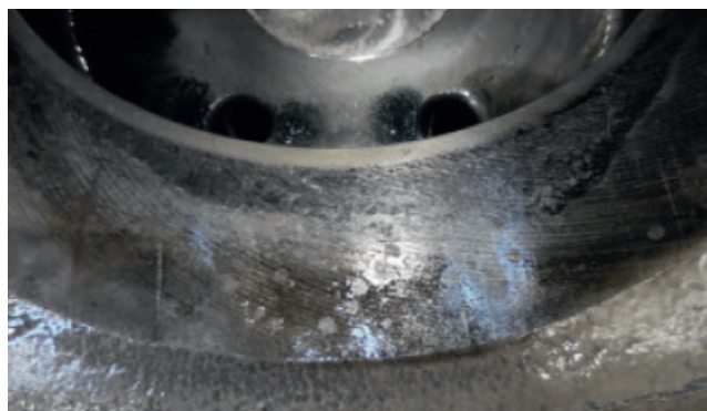
Uszkodzenia powierzchni wskutek mikrotarcia w skrzyni biegów
