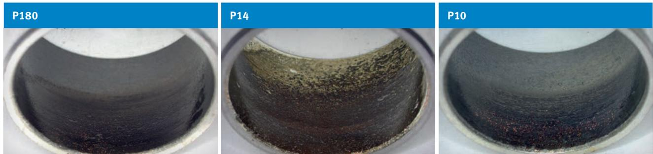
Usure de la couche de glissement sur les coussinets P180, P14 et P10 après le test de rotation en fonctionnement à sec avec charges radiales
