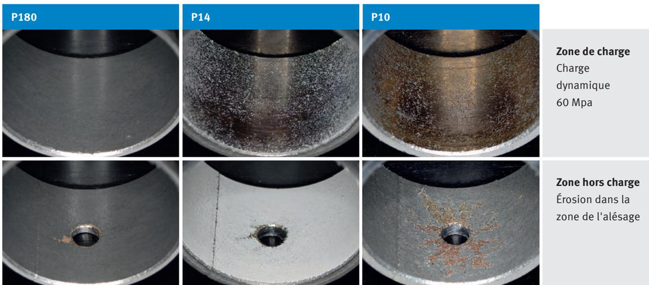
Usure de la couche de glissement sur les coussinets P180, P14 et P10 après le test de rotation en fonctionnement humide
