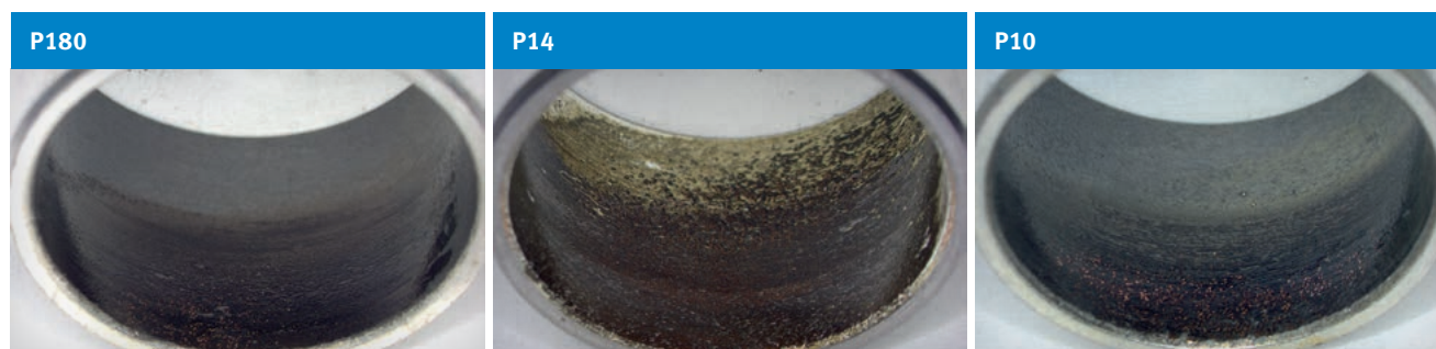
Usura dello strato di strisciamento nei cuscinetti a strisciamento P180, P14 e P10 dopo il test di rotazione nel funzionamento a secco con carico sugli spigoli
