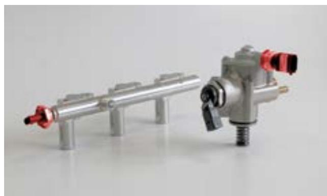
Sensores de presión de combustible (resaltados) en el tubo de distribución de combustible y en la bomba de alta presión
