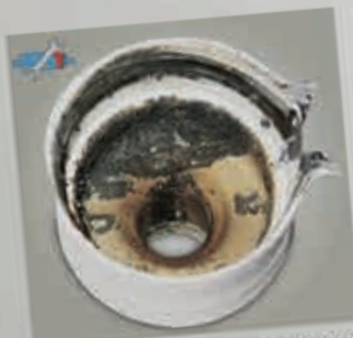
Rys. 18: Widok na rozciętą obudowę pompy z pierścieniem zębatym E3T – zapchaną osadami
