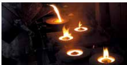
活塞环坯件的铸造(模具铸造)
