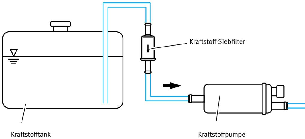
Die Siebfilter lassen sich in die Kraftstoffleitung zwischen Kraftstofftank und Kraftstoffpumpe vom Typ E1F (mit einem Durchmesser von 8 mm am Saugstutzen) einbauen.
