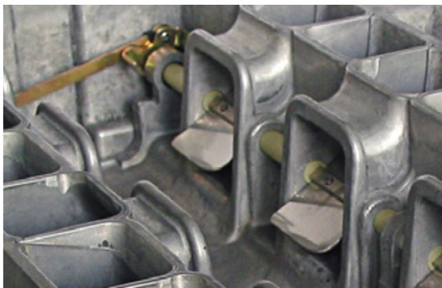
Vue de l'intérieur d'une tubulure d'aspiration à commande
