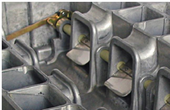
Uno sguardo all'interno di un collettore di aspirazione a geometria variabile
