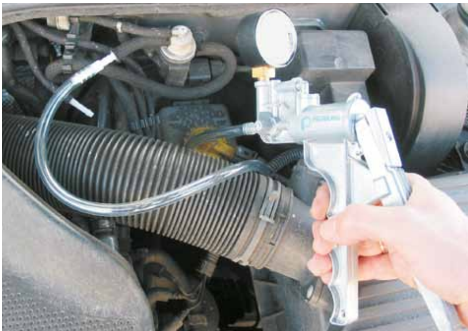
Verificação de um EPW com a bomba de vácuo manual (VW Golf IV)
