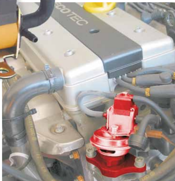
Válvula EGR com EDW montado (destacado a vermelho) no Opel Astra
