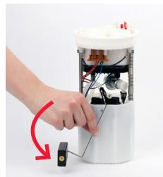
Platzieren Sie das Ende des Arms in der Öffnung am Sensorelement an der Seite der Kraftstoffförderseinheit.
